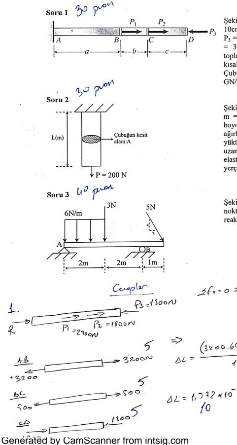
Şekildeki dairesel kirişin kesit alanı  $10 \text{cm}^2 \text{ dir. } P_1 = 2700 \text{N}, P_2 = 1800 \text{N},$  $P_3 = 1300N$ , a = 60cm, b = 24cm, c= 36cm olduğuna göre çubuktaki toplam eksenel uzama (ya da kısalma) miktarını hesaplayınız. Çubuğun elastik modulü E = 100  $GN/m^2$  dir.
