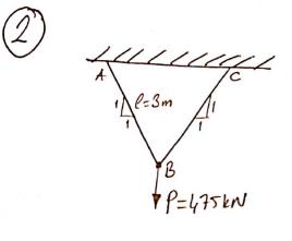
Birbinnun aynı illi aelik çubuk 475 kN'luk yok ile yoldenmiştir. Gubulderdeli normed perilmenn 200 MPo'den pozla eluenesi i'cin kesit alarlanın en az kacı eluesi perelikiçini bulunız. (Cenep: A=1680 mm²].
