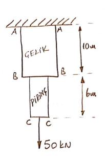
I'ki pirizwatik aubuk birbirine rijit bir sekilde eklenwis owp sekildeki gibi 50kulluk dusey yoku tutwaktodir. Gelipin apirlipi 2,620N, kesiti 6000m2 'dr. Pirincin apirlipi 2675N ve kesiti 5000m2 'dr. Eaelik= 200 GN/m2, Epnna= 90 GN/m2 Bu nolzewekin herbirindeli gerilweyi bulunuz. (Ceop: Gelik ian A-A kesihudeli perilwe en boyok
